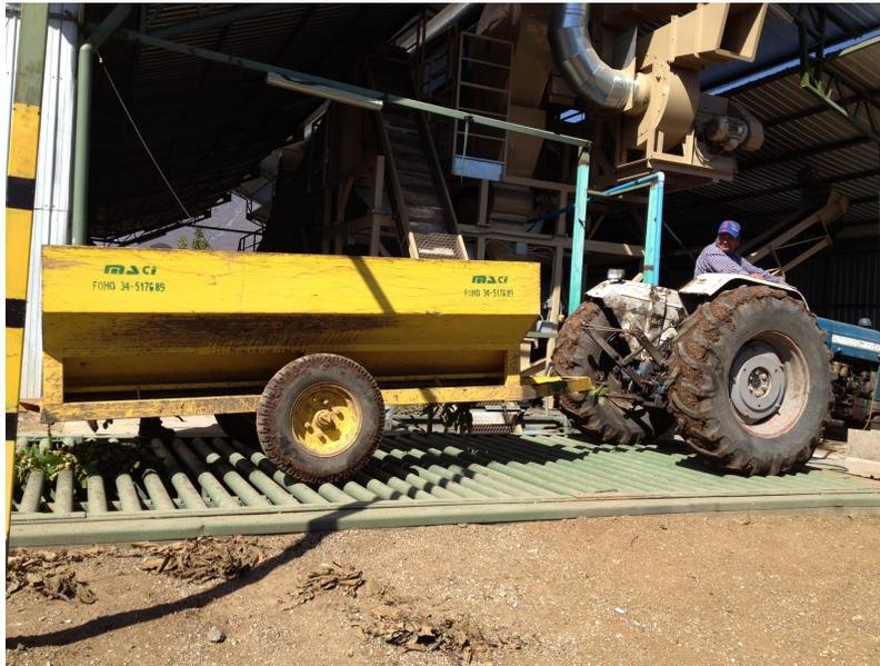
**CARRO CONICO DESCARGA INFERIOR**
