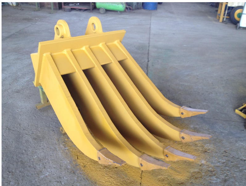
RIPPER ROMPE TERRENO
